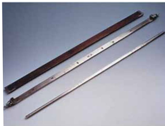
Fig. 3.- Patrón y varas de medir, una de madera 5 y la otra de acero, conservadas en La Real Academia de la Historia de Madrid.
